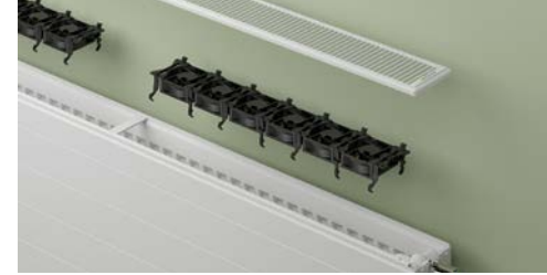
Der Wärmepumpen-Heizkörper x-flair vereint die bekannte x2-Technologie mit einem intelligenten Lüftersystem. Durch die maximale Wärmeabgabe ist x-flair optimal geeignet für Wärmeerzeuger im Niedertemperaturbereich, wie Wärmepumpen. Die Lüfter schalten sich bedarfsorientiert vollautomatisch ein und aus. © Kermi GmbH
